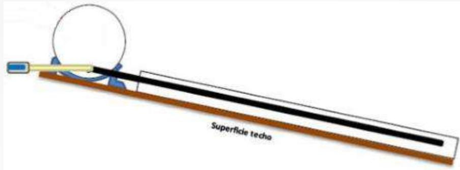
El calentador debe de ser instalado en partes altas como techos o estructuras adecuadas que soporten el peso del sistema.
